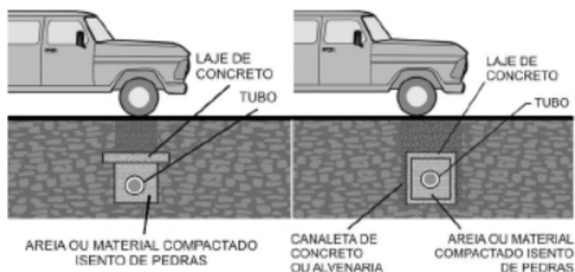
Figura 2 - Lajes e canaletas para proteção de tubulação.
